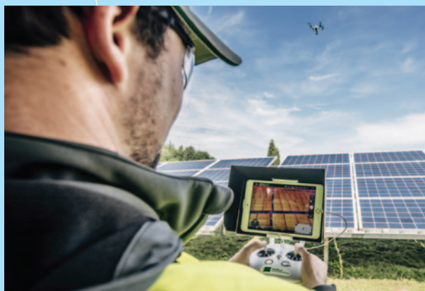
Inspección aérea termográfica. © BayWa r.e.
